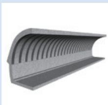
トンネル補強CFRP帯板接着 ガイナSHシートボード工法
