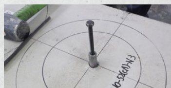
STEP3 固定ジグ・反力ホルダ取付
