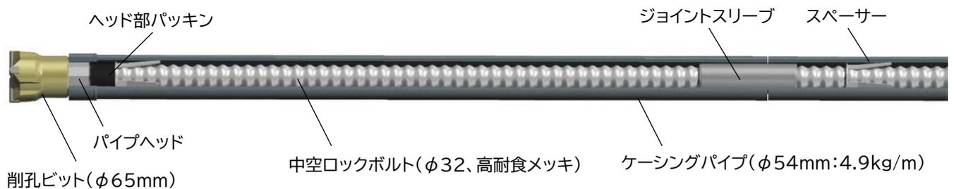
ロックボルトにセットしたスイベルよりエア等を供給して所定深度まで削孔します。
