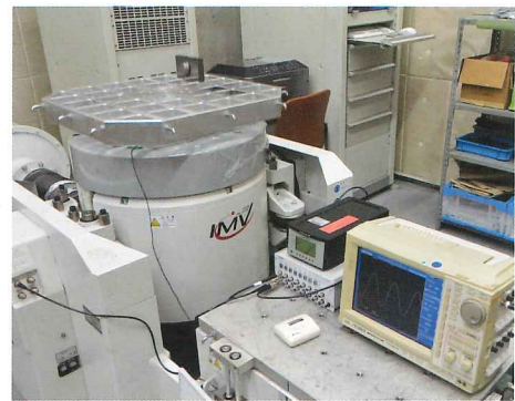
ゆるみ止めKナットはNAS3350・3354(米国航空宇宙規格)に準拠した振動衝撃試験に合格した材料です。
