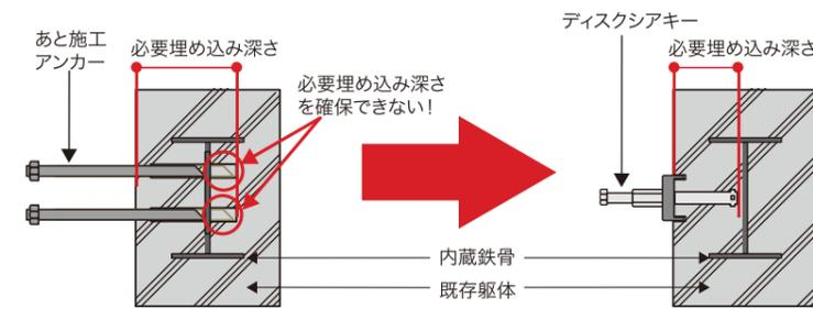
SRC造は鉄骨までのかぶり厚さが足りず、在来工法(あと施工アンカー)の適用が困難な場合があります。ディスクシアキーは、コンクリート種別を問わず埋め込み深さは最短で90mm(標準:140mm以上)から適用できるため、SRC造の建築物の耐震補強に最適です。また、RC造建築物にも使用可能です。
