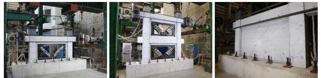
一層架構実験 二層架構実験 増設補強壁実験
