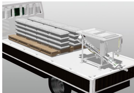
モルタル系注入システム
