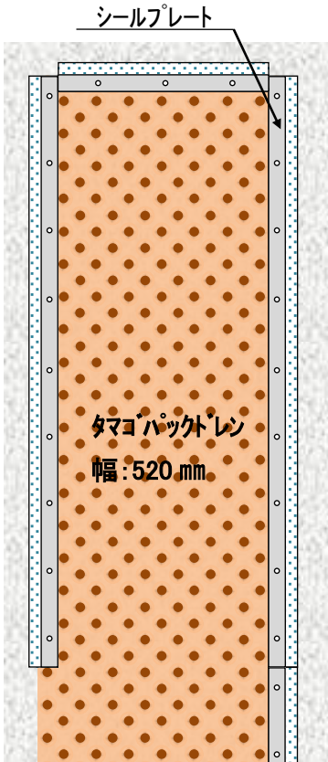
FILM 工法でのタマゴパックドレン設置例
