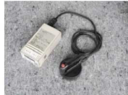
斜面シート固定用 電磁誘導溶着機 (斜面施工時のみ使用)
