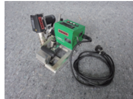
パデムシート溶着用 自走式溶着機
