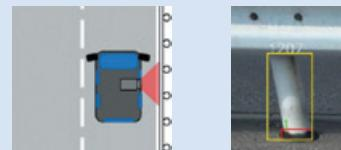
「ガードレール支柱腐食点検システム」の撮影イメージ
