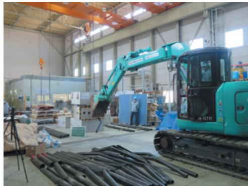
AGF・Me端末管の切除確認試験状況
