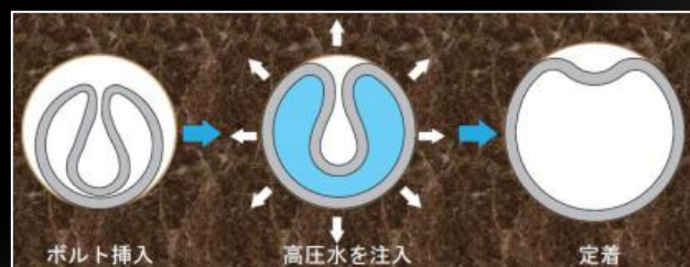
(膨張型ロックボルトの定着機構)
