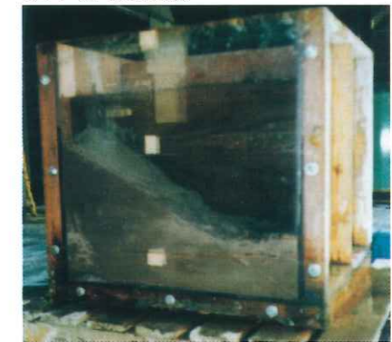
水中打設試験
