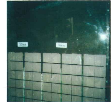
亀裂漏洩性試験
