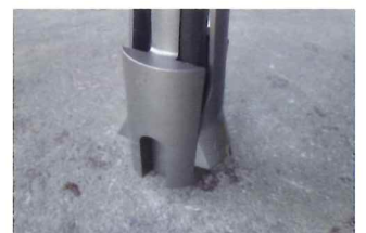
拡底ビット(拡底状況)
