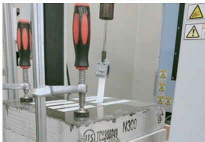
引き剥がし試験
