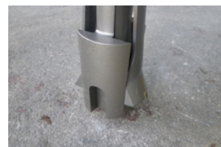
拡底ビット(拡底状況)
