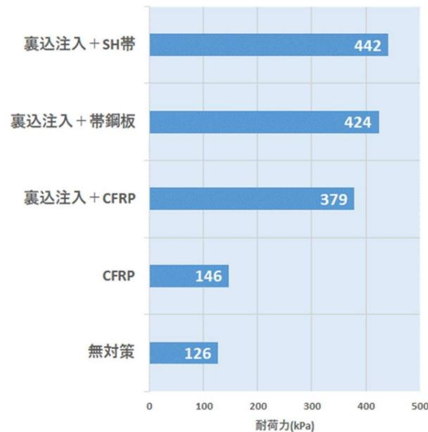
※覆工モデルは、NEXCO 標準断面(監視員通路/3級 A・B)、矢板(t=600mm)、背面空洞、インパートなし
