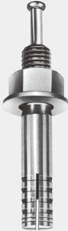
おねじ呼び径とアンカーボディの径が等しく、取付け物の上から施工が可能であり、芯棒を打設することによりアンカーの拡張が可能で、専用打込み棒が不要です。芯棒が規定の位置まで到達していることが目視にて確認可能で、施工管理も容易にできます。
