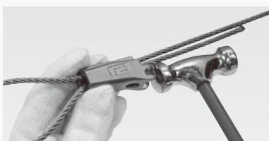
5 くさびが正しく打込まれ、ロープがしっかりと垂直配列に固定されているかを確認します。
