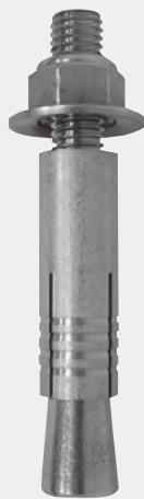
アンカーボルトを打設し固定させた後、付属の座付きKナットで充分に締付けることにより拡張部が追随拡張し、より安定した強度が得られます。座付きKナットは、Kナットとワッシャーを一体にした製品であるため施工性に優れます。加えて、ゆるみ止め効果の保持によりナットの脱落や取付物の落下事故を未然に防ぐ安全対策製品です。
