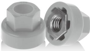
樹脂キャップとゆるみ止めKナットを組合せました。ゆるみ止めKナットは、フリクションリングがねじ山を強く押さえることによりゆるみを防ぎます。
