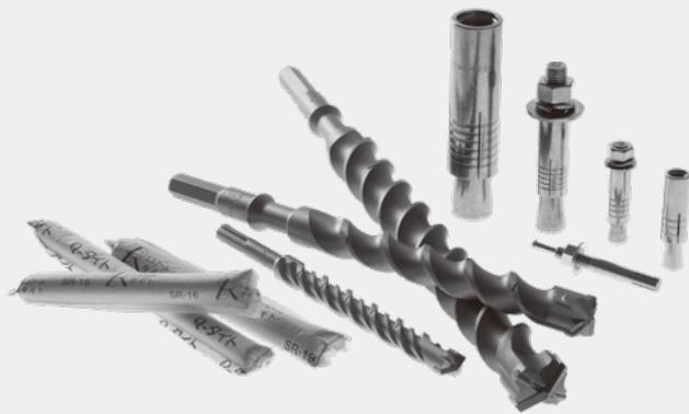
コンクリート、モルタル、ブロックなどを穿孔するためのドリルビットです。4枚刃で2枚刃よりも穿孔穴が真円状となり当社のアンカーボルト（金属系、接着系アンカー）の施工に最適です。ドリルのボディ部に一定区間毎のマーキング溝があり、穿孔長の目安としてお使いいただけます。
