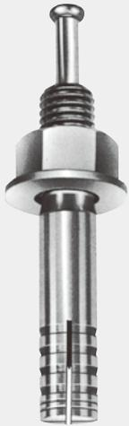
おねじ呼び径とアンカー本体の径が等しく、取付け物の上から施工が可能であり、芯棒を打設することによりアンカーの拡張が可能で、専用打込み棒が不要です。芯棒が規定の位置まで到達していることが目視にて確認可能で、施工管理も容易にできます。
