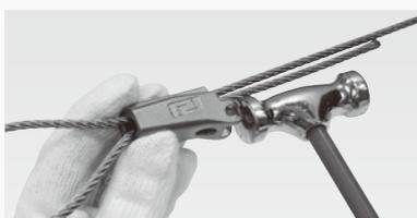
5 くさびが正しく打込まれ、ロープがしっかり垂直配列に固定されているかを確認します。
