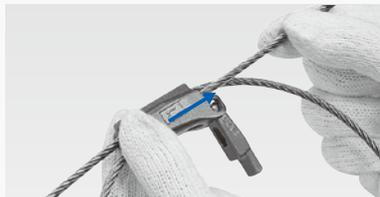
3 ロープの端末長を調整して本体にくさびを挿入します。【張り出し長は100mm以上】
