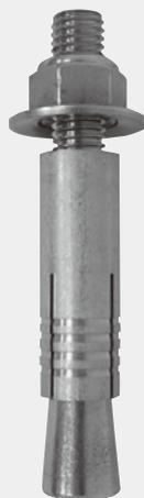
アンカー打設し固着させた後、付属の座付きKナットで十分に締付けることにより拡張部が追従拡張し、より安定した強度が得られます。座付きKナットは、Kナットとワッシャーを一体にした製品であるため施工性に優れます。加えて、ゆるみ止め効果の保持によりナットの脱落や取付物の落下事故を未然に防ぐ安全対策製品です。
