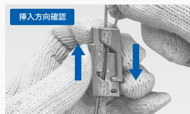
4 プライヤー等でスクラムクランプを押し込む。(▲マークが重なる位置まで押し込む)
