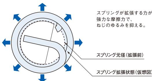
スプリングが拡張する力が働き、強力な摩擦力で、ねじのゆるみを抑える。
