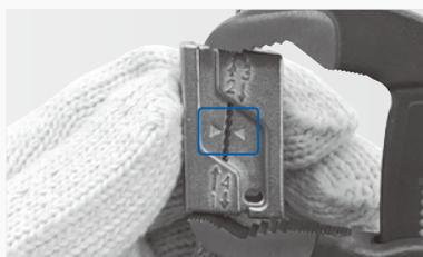
6 所定の割ピンを挿入する。取付完了。
