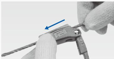
2 ロープをリング状にして“2→”の指示に従いロープを通し、端末を引き抜きます。
