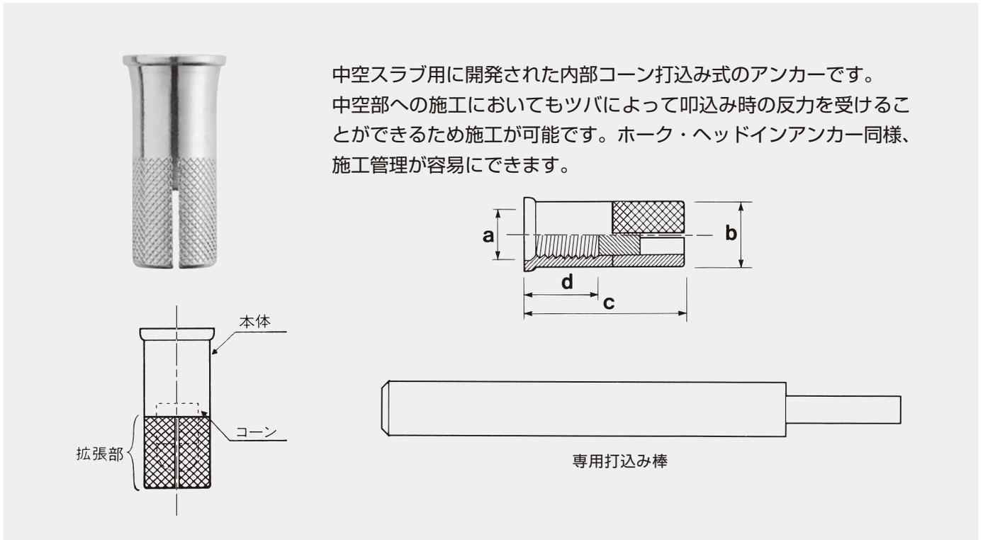
中空スラブ用に開発された内部コーン打込み式のアンカーです。中空部への施工においてもツバによって叩込み時の反力を受けることができるため施工が可能です。ホーク・ヘッドインアンカー同様、施工管理が容易にできます。
