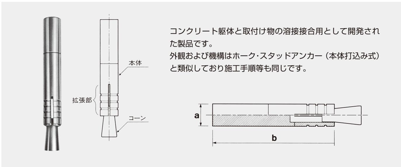
コンクリート躯体と取付け物の溶接接合用として開発された製品です。
