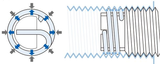
ねじ込まれた状態では、スプリングに対し**圧縮**の力が加わるため、その**反力**により、スプリングとめねじ面に圧力がかかったまま接している。
