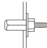
③ 専用ドライバーにて締付け
