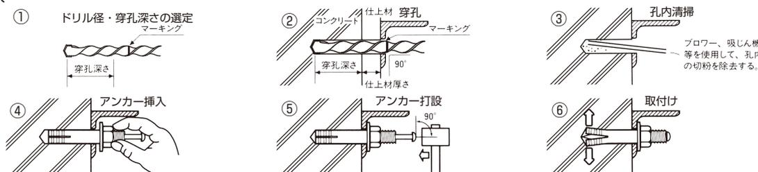
※ご注意：アンカーにセットされた座金の座面が、取付け物の面と接着していることを確認して芯棒を打設して下さい。
