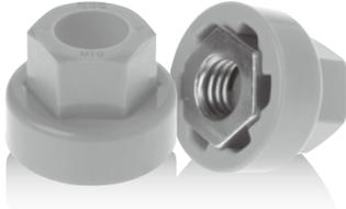
樹脂キャップとゆるみ止めKナットを組合せました。ゆるみ止めKナットは、フリクションリングがねじ山を強く押さえることによりゆるみを防ぎます。
