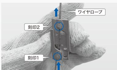
2 もう片方のワイヤロープをスクラムクランプの 矢印(刻印3→4)方向に挿入して引き出す。
