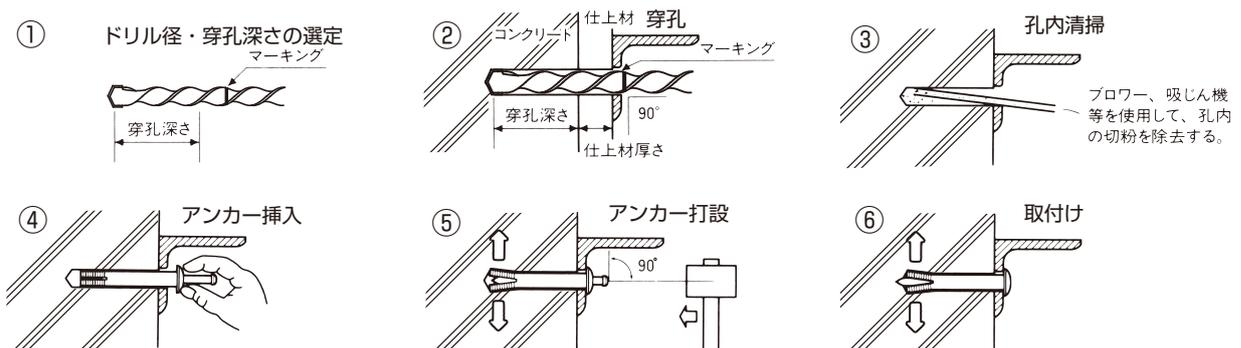
※ご注意：アンカー頭部座面が、取付け物の面と接着していることを確認して、芯棒を打設して下さい。
