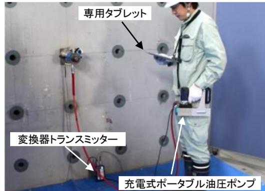
④充電式ポータブル油圧ポンプ、トランスミッター、専用タブレットをセットします。
