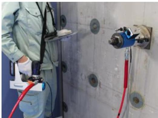
⑤充電式ポータブル油圧ポンプのトリガーを引いて载荷します。計測は設定された荷重ごとに自動的に記録されます。
