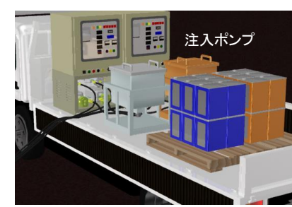
(レジン系注入システム概要図)
