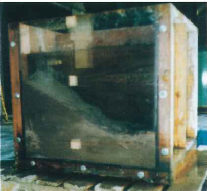
水中打設試験
