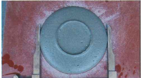
A液+B液(可塑材)添加後のフロー値測定
