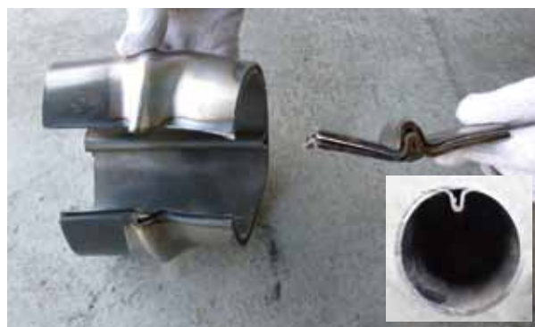
【支柱-補強材定着状況】
