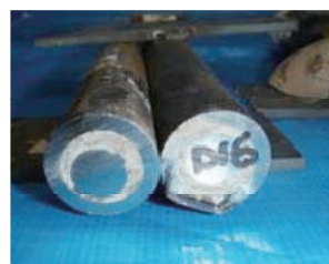
D16:電気ハンマードリル充填状況
