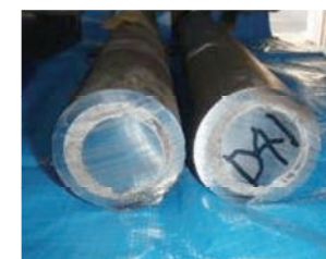
D41:電気ハンマードリル充填状況
